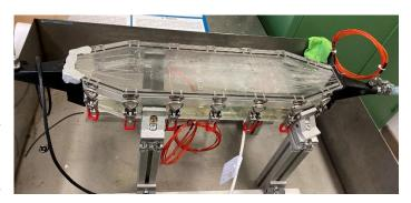
trischen Fluid zur Anwendung kommen, welches die elektrischen Komponenten durch direkten Kontakt kühlt. Um Simulationsergebnisse der Kühlfluide zu verifizieren, sollen die Ergebnisse mit denen eines Grundlagenexperiments verglichen werden.
